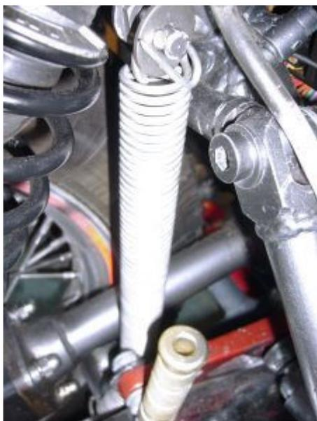
*Eine Feder hält das Getriebe mit dem rückwärtslaufenden Rad oben.*
