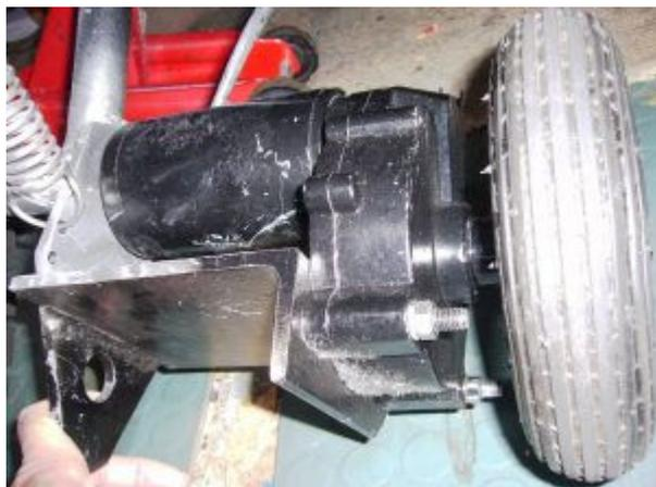
Das Prinzip meiner Rückfahrhilfe ist schnell erklärt: Zwischen Motorrad und Beiwagen kommt ein viertes Rad. Es kann manuell auf den Boden gedrückt werden, ist elektrisch angetrieben und läuft auf Knopfdruck rückwärts.
